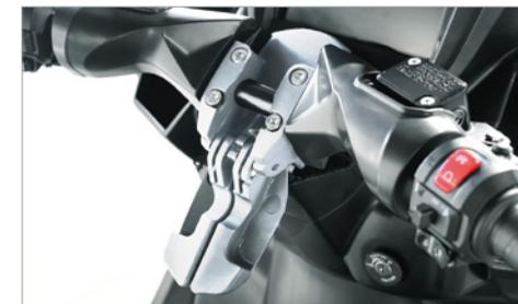
Doppia leva Roll-Lock per il blocco verticale del veicolo in sosta e Freno a mano di stazione con bloccasterzo a chiave: salita e discesa guidatore da entrambi i lati.
