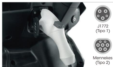
Dotato di serie di presa J1772 (Tipo 1) o Mennekes (Tipo 2), per allacciarsi alle infrastrutture di ricarica auto, oltre al cavo di serie per la presa domestica 100-220 V.
