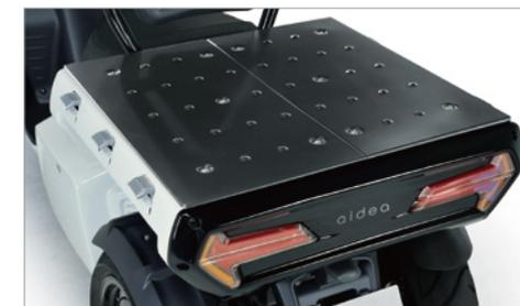
Ampio pianale di carico con molteplici punti di ancoraggio (ai lati e sotto il cofano) per montare sia bauli in commercio, sia allestimenti professionali speciali.
