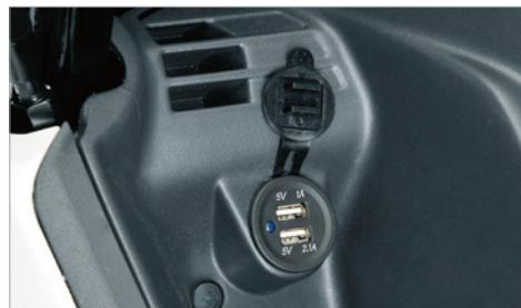
Doppia presa di alimentazione USB (5V1A / 5V2A) per alimentare dispositivi mobili; tre alette sono compatibili al montaggio di supporti smartphone commerciali.
