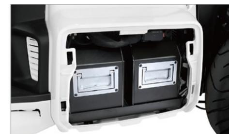
Il veicolo può alloggiare a fianco del pacco batteria di serie anche una batteria ausiliaria, entrambi dotati di BMS e 336 celle Panasonic di formato 18650 ad alte prestazioni.
