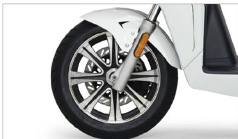
Sia la ruota anteriore, sia le 2 posteriori sono dotate di cerchi da 13 pollici con battistrada posteriore maggiorata, per una guida stabile anche a pieno carico e sullo sconnesso.
