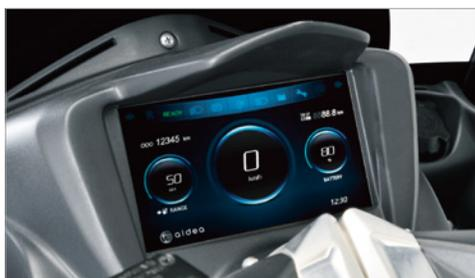
Il cruscotto multifunzione LCD a colori visualizza graficamente con la massima chiarezza velocità, livello della batteria, autonomia e parametri tecnici.
